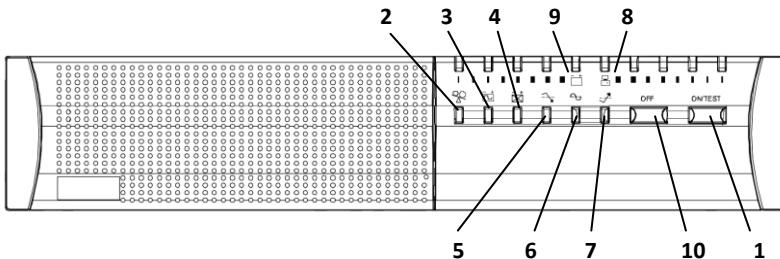
**1.1.1 Кнопка “ON/TEST”:** После подключения ИБП к электросети нажмите кнопку ON/TEST для включения ИБП и питания оборудования. При включенном ИБП нажатие кнопки ON/TEST активирует функцию встроенного контроля (самодиагностики) ИБП.
